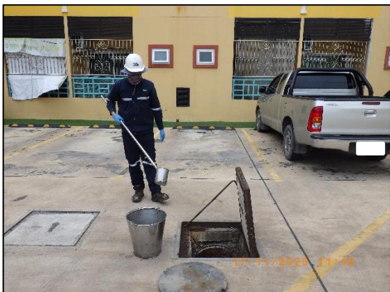
(2) บ่อตรวจสอบคุณภาพน้ำทั้งหลังจากจากระบบบำบัดน้ำเสีย ตึก A
